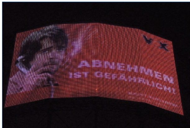
Figuur 2. Te dichtbij en een slechte kijkhoek – LED's hebben afstand nodig en een blik recht van voren (Foto: Ströer).
