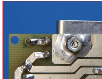
Figuur 6. Bij kleine dissipatievermogens is de warmteafvoer door een aan de achterzijde op een kopervlak gesoldeerde M3-moer voldoende.
