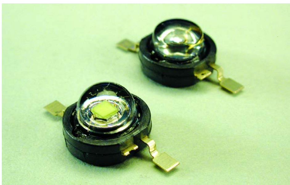
Figuur 2. Luxeon-LED's met een opgenomen vermogen van 1 W.
