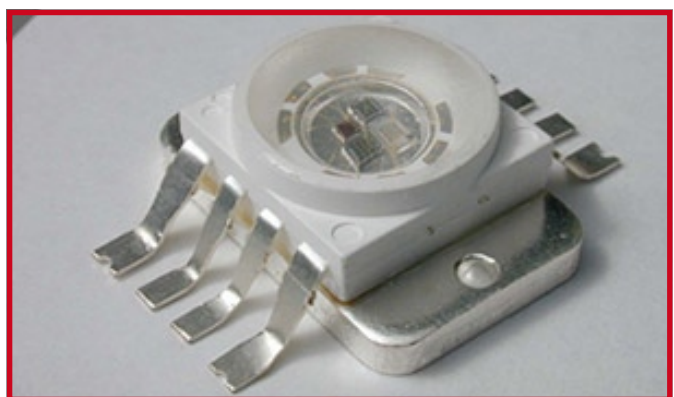
De 'BL3A4' van Plus Opto bereikt 150 lm bij 4 x 350 mA (vier chips in één 8-pens LED-behuizing).
