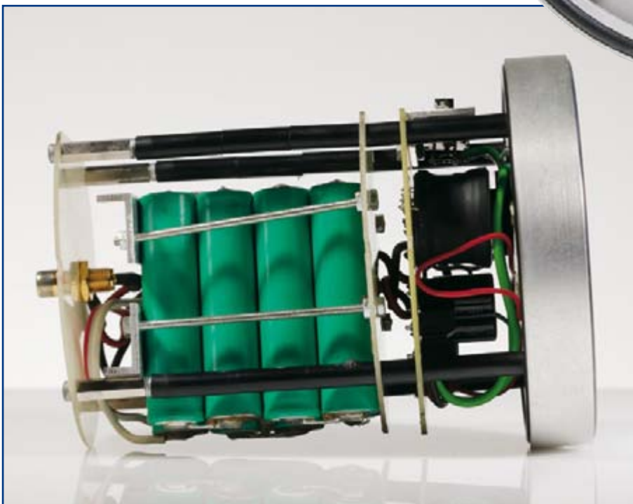
Figuur 4. Met een aantal afstandsbuisjes en lange schroeven is een praktisch geheel te realiseren, dat stabiel in de behuizing kan worden geplaatst.
