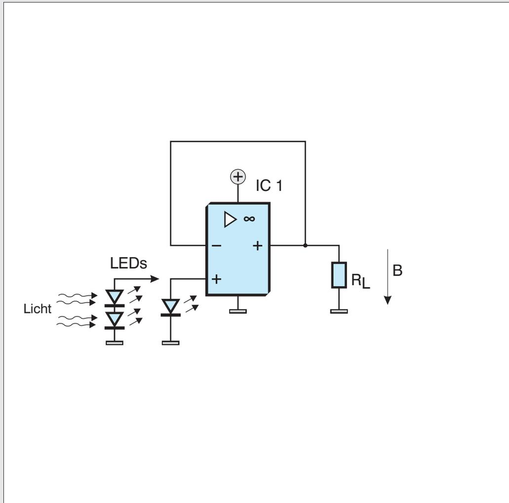
Die Messschaltung als TransimpedanzVerstärker, um die Photospannung der Sensor-LEDs entsprechend der Tageslichtstärke zu gewinnen.
