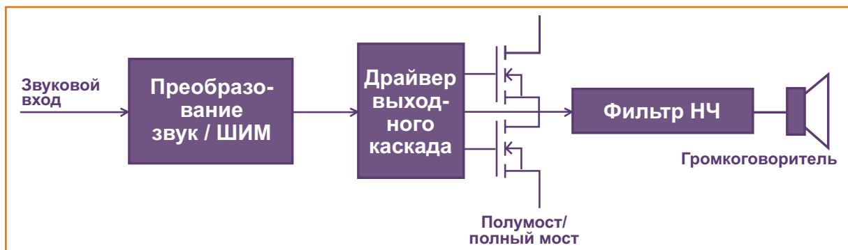
Рисунок 2. Путь прохождения сигнала в усилителе класса D.
