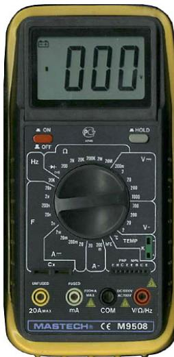
Этот мультиметр сконструирован в соответствии с IEC-1010, касающийся электронной измерительной техники с категорией перегрузок CAT II и загрязнения 2.
