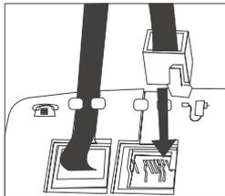
Stecken Sie zuerst den kleinen Stecker in die gekennzeichnete Buchse auf der Unterseite der Basisstation ein (Abb., Pfeil), und legen Sie die Schnur in den davor befindlichen Kabelkanal. Vergewissern Sie sich, dass der Stecker fest in der Buchse steckt. Wenn der Stecker nur lose sitzt, kann es zu Kontaktabbrand kommen.
