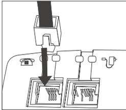
Sie dürfen die Basisstation nur über die mitgelieferte Telefonanschlussschnur mit dem Telefonnetz verbinden. Auf keinen Fall dürfen Sie die werkseitig montierten Stecker abschneiden oder die Basisstation anderweitig mit dem Telefonnetz verbinden! Andernfalls verliert Ihr Sinus 310 die Genehmigung zum Betrieb am öffentlichen Telefonnetz.
