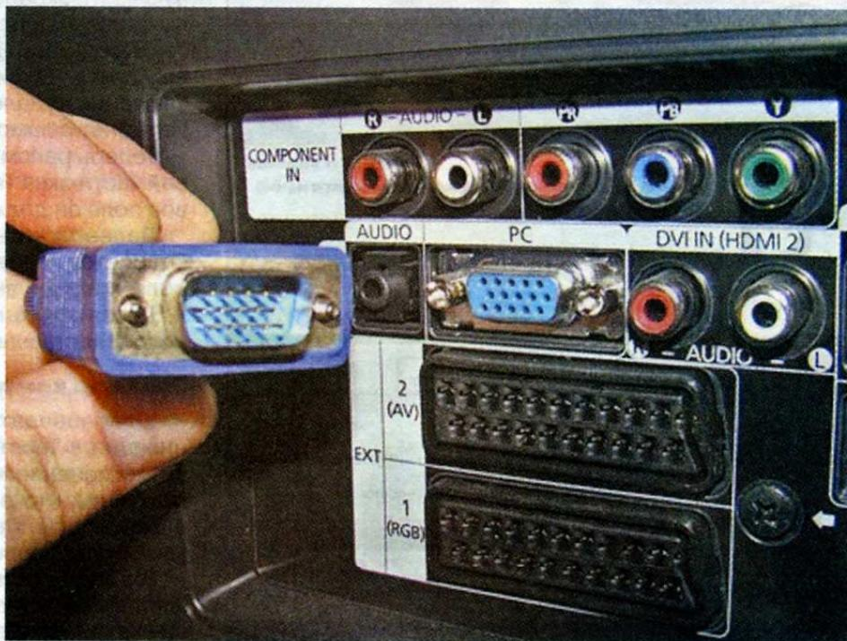
\* VGA: У компьютера, не имеющего цифровых видеовыходов, наилучшее качество изображения обеспечивает разъем VGA. Если в телевизоре отсутствует вход VGA, то можно использовать адаптер для входа YUV.
