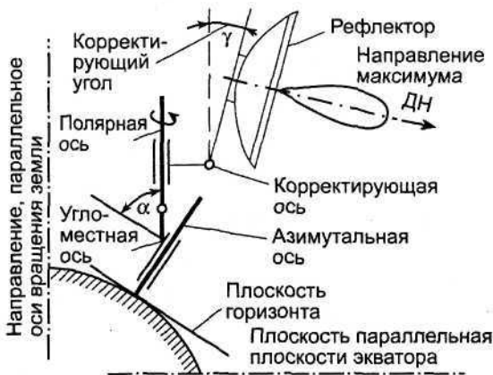
Рис. 9. Основы конструкции антенны с полярной подвеской
