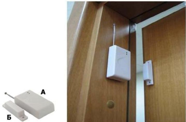
Для массивных металлических дверей (гаражи, металлические тенты-палатки) следует пользоваться специальным магнитоконтактным датчиком. Для такого датчика расстояние срабатывания 3,00-5,00 см.
