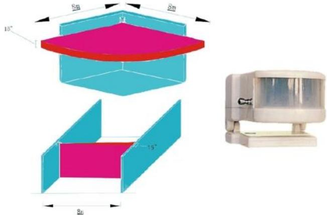
Угол обзора такого датчика около 80 градусов, так что его лучше всего вешать в углу комнаты напротив входной двери. **Направлять датчик на окно НЕЛЬЗЯ!** Этот датчик может применяться при установке на остекленных дачных террасах или остекленных балконах.
