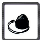
HIQ-TR-0113 ИК-подсветка для внутренней установки в черном корпусе. 48 светодиодов позволяют освещать объекты в темноте на расстоянии от 20 до 30 м. Угол светового потока - 60°. Длина волны 830 нм. Рабочее напряжение 12V, ток до 300мА.
