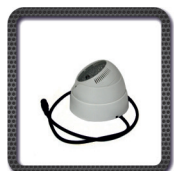
HIQ-TR-0112 ИК-подсветка для внутренней установки в белом корпусе. 48 светодиодов позволяют освещать объекты в темноте на расстоянии от 20 до 30 м. Угол светового потока - 90°. Длина волны 830 нм. Рабочее напряжение 12V, ток до 300мА.
